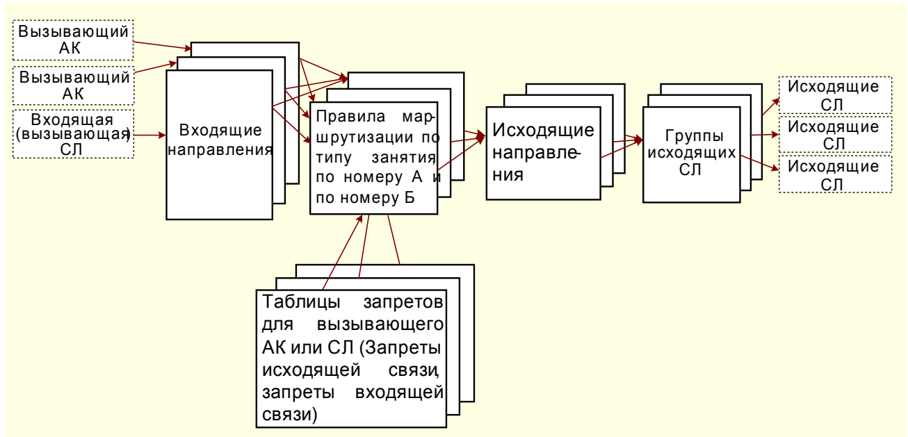
Рисунок 5.10 – Структура обработки вызова от АК или СЛ на исходящую СЛ.
