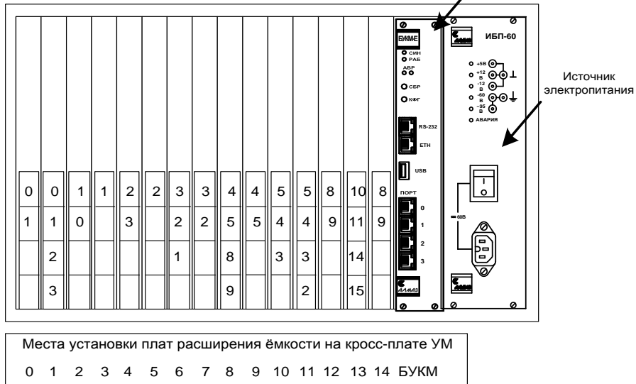
Рисунок 3.8 – Места установок ЭМ1 в МР и УМ и номера выведенных на эти места ВГТ на основе кросса 15
