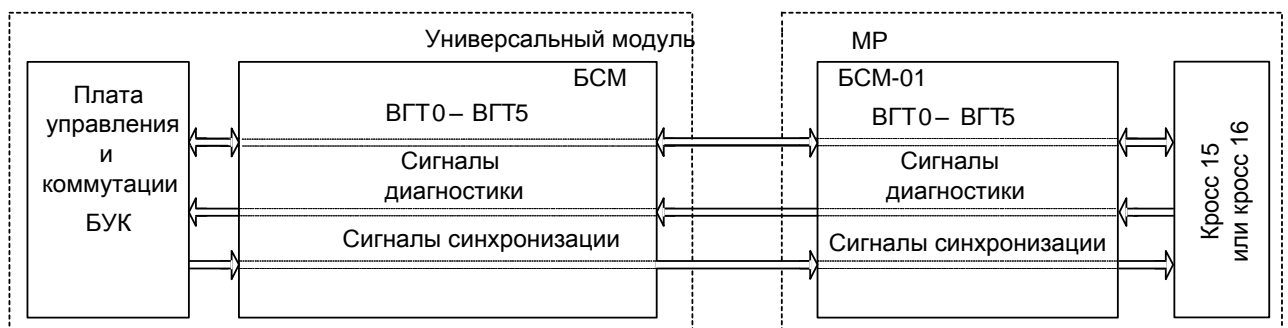
Рисунок 5.13 – Прохождение сигналов между универсальным модулем и МР
